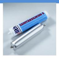
Gebrauchsfertige, luftfeuchtigkeitshärtende Einkomponenten-Dichtungsmasse auf Silikonbasis, acetatvernetzend. Das Material ist lichtecht, feuchtraum- und witterungsbeständig.
